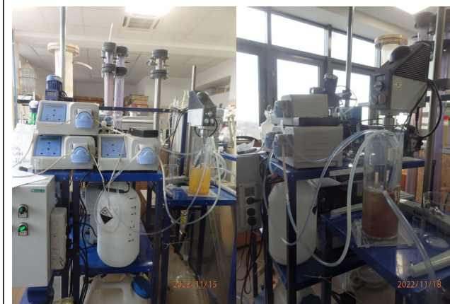
Foto - Validare faza cheie, oxidare efluent tiosulfatic cu H 2 O 2 , model de validare cu regim de curgere continua
